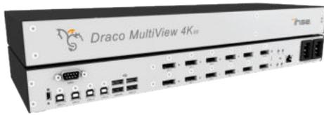
Possibilité d'afficher **4 sources vidéo différentes sur le même écran** suivant différents modes d'affichage paramétrable (plein écran, mode Quad, mode PiP en incrustation de fenêtres) **avec le support d'un seul ensemble clavier/souris pour commuter entre les 4 sources.**
