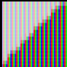
Les signaux vidéo sans mappage des pixels peuvent afficher des contours flous
