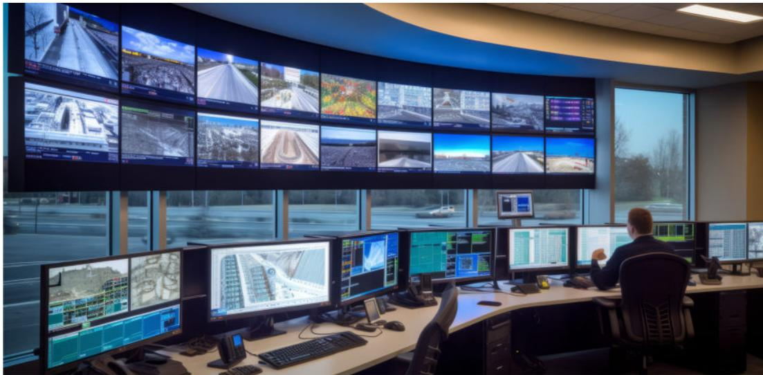
Les murs d'écrans sont constitués de plusieurs écrans de haute résolution disposés côte à côte pour créer une surface d'affichage étendue. Ils permettent aux opérateurs des CSU de visualiser de grandes quantités d'informations en même temps, offrant ainsi une vue d'ensemble plus complète de la situation en direct.
